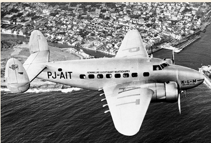
Lockheed Model 14 Super Electra (de civiele versie van de Lockheed Hudson), die bij de KLM WIB ingericht was voor 11 passagiers (i.p.v. 14 in de standaardversie). KLM WIB gebruikte de Lockheed 14 o.a. ook voor lange routes zoals vluchten naar La Guaira, Trinidad en Barbados en naar Miami. Bron KLM photo
